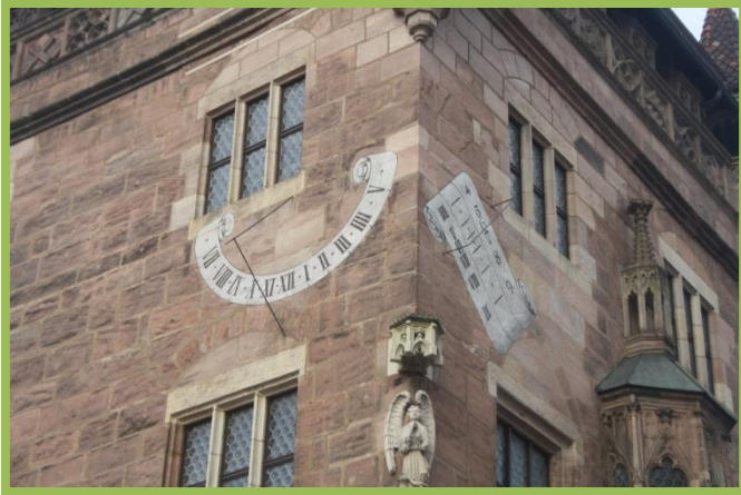
Imatge 50. Dos rellotges perpendiculars entre sí en un mateix edifici. El de l'esquerra està orientat al sud i el de la dreta a l'est (Rellotge lateral). Nuremberg, Alemanya
