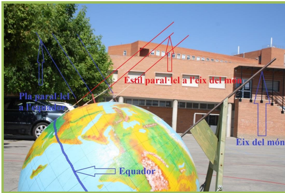
Imatge 72. Relloges de sol equatorials situats en diferents punts del mateix meridià. S'observa que els plans dels rellotges situats a diferents latituds són paral·lels entre sí, i paral·lels a l'equador.
