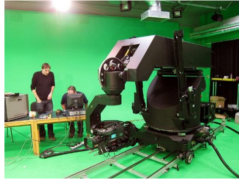
Càmera de filmació acoblada a un braç robòtic sobre rails.
