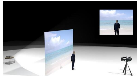
Representació gràfica de la tècnica de projectió posterior o retroprojectió
