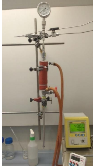
Figura 4. Reactor on es sintetitzen les nanopartícules mitjançant el mètode DELOS-SUSP.
