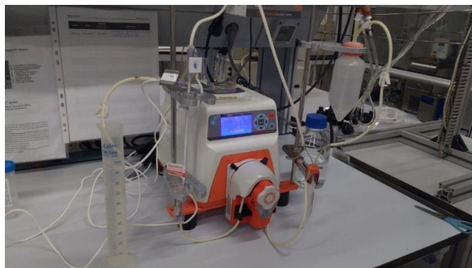
Figura 7. KrosFlo Research Ili TFF System, diafiltrador per a purificar les nanopartícules.
