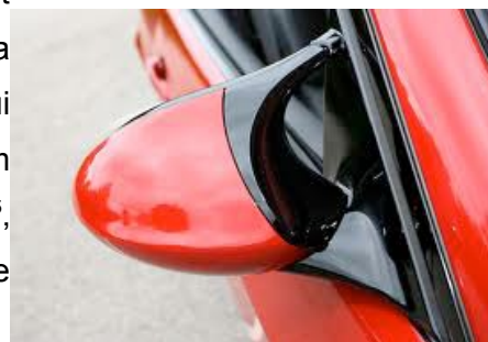
Figura 23: retrovisor amb poc drag
