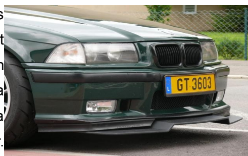
Figura 25: exemple de splitter
