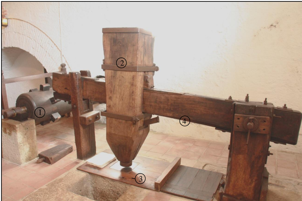
1. Arbre de lleves 2. Mola 3. Planxó de ferro o calandra 4. Telera
