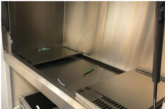
Imatge 4: Cabina de seguretat biològica. Produeix un flux d'aire cap a l'exterior que fa que les partícules en suspensió de l'aire caiguin al terra de la cabina, tot així evitant contaminacions causades per bacteris o espores en l'aire.
