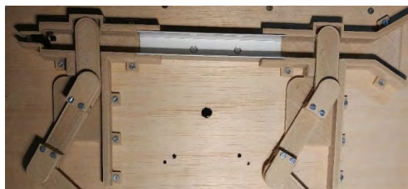
Figura 57. Carril de guia per on es fa la subjecció amb el carro. Elaboració pròpia
