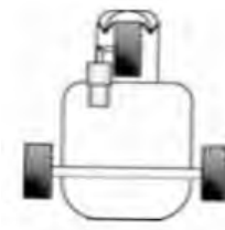
Figura 8. Configuració en tricicle (Barrientos Sotelo & García Sánchez, 2007)
