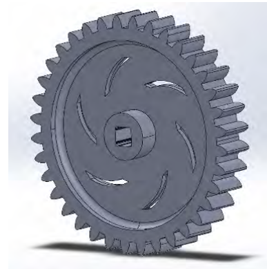
Figura 47. Engranatge de 36 dents i 38.1 mm de diàmetre. Elaboració pròpia
