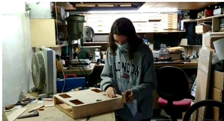
Figura 26. Procediment d'arrodoniment de cantonades del robot. Elaboració pròpia
