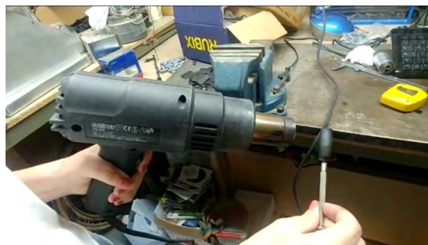
Figura 55. Elaboració dels corrons amb el tub termoretràctil. Elaboració pròpia
