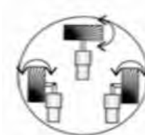
Figura 11. Configuració omnidireccional (Barrientos Sotelo & García Sánchez, 2007)
