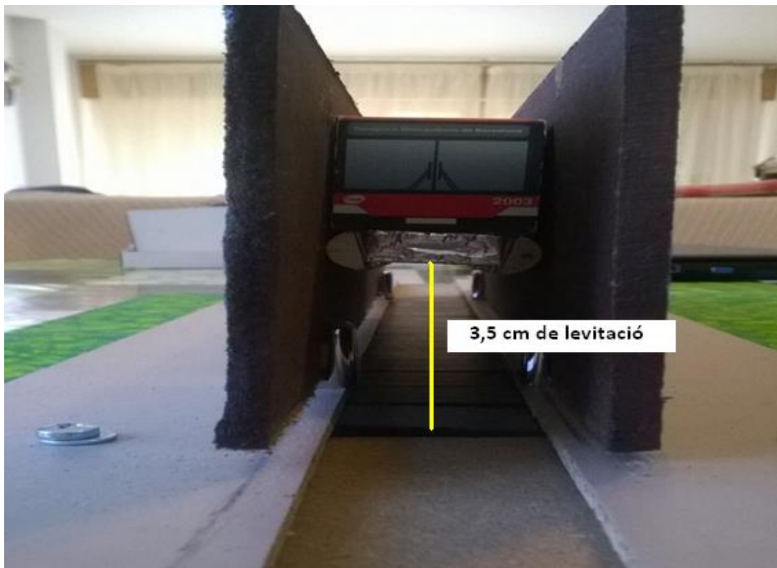
Figura 5.5 La levitació del tren i l'alçada a què aconsegueix arribar.
