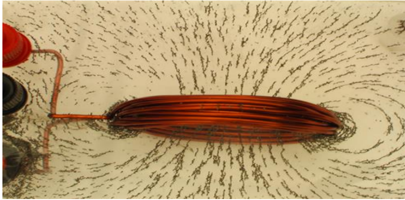
Figura 1.21 Els pols que es produeixen en passar corrent per una espira circular.
