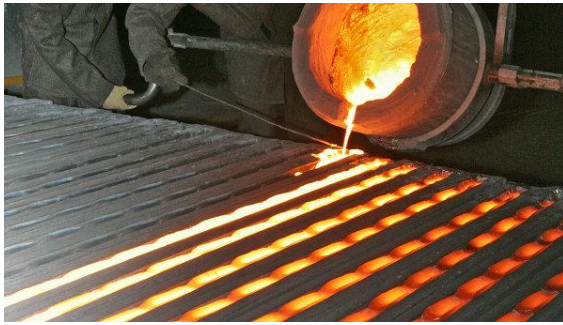
Figura 1.35 Col·locació de l'aliatge obtingut en motlles per obtenir la forma desitjada.
