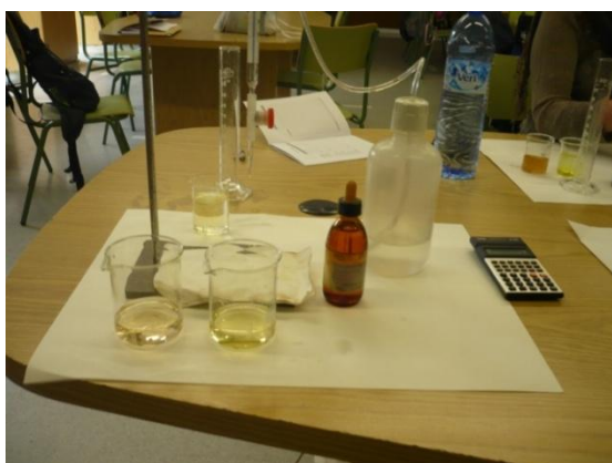
Fig. 8.1. i 8.2. Valoració de l'alcalinitat. Quan l'ataronjat de metil canvia de color groc a rosat, s'atura el procés i s'anoten els mL d'àcid sulfúric utilitzats.
