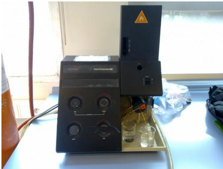
Fig. 7.4. Fotòmetre de flama que permet mesurar la concentració del sodi i el potassi.
