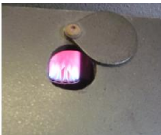
Fig. 8.11. i 8.12. Flama violeta produïda pel potassi i flama taronja produïda pel sodi.
