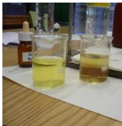
Fig. 8.13. i 8.14. Valoració dels clorurs que passa de color groc llimona al groc orina.
