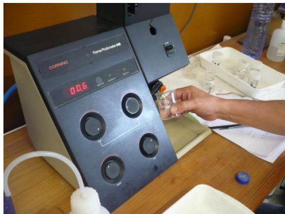
Fig. 8.10. Fotòmetre de flama utilitzat per mesurar el sodi i el potassi.
