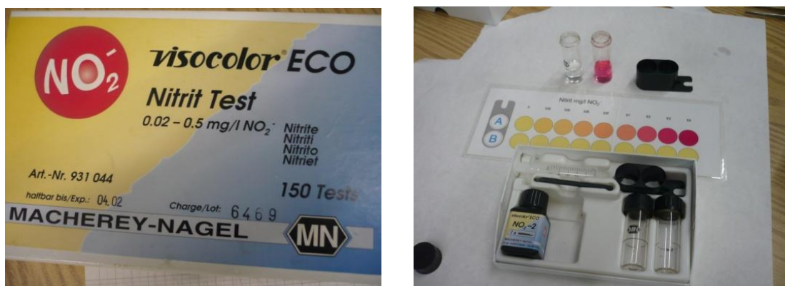
Fig. 8.17. i 8.18. Kit utilitzat per mesurar els nitrits.
