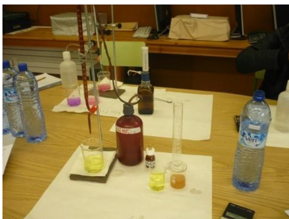
Fig. 8.13. i 8.14. Valoració dels clorurs que passa de color groc llimona al groc orina.
