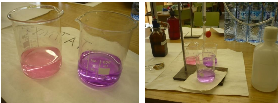
Fig. 8.7. i 8.8. Valoració del calci amb la qual es veu un viratge de rosa a violeta.
