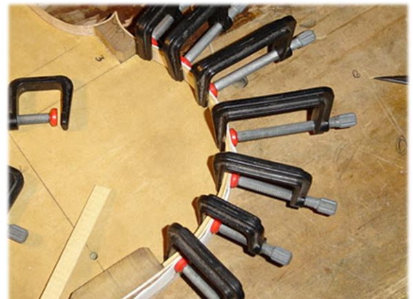
101. Creant el contorn del violí al voltant del motlle. Hi ha els tacs, els riscles i els contrariscles.
