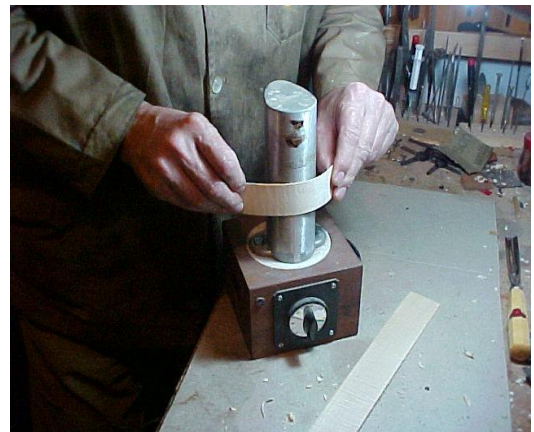
100. Donant forma els riscles en calent amb el ferro de doblar.
