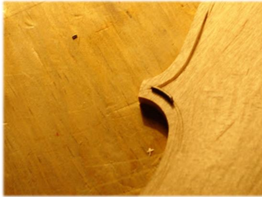
113. Elaboració del filet sobre el canal.
