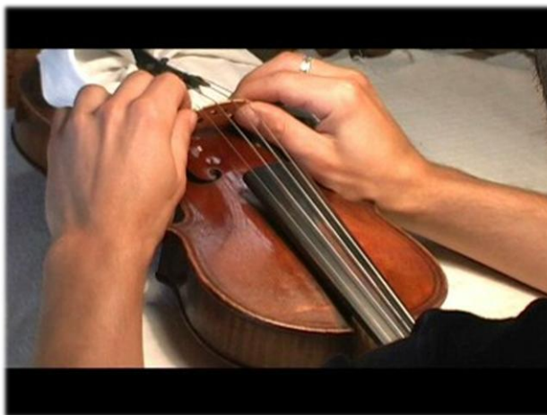
132. Col·locant el pont.
