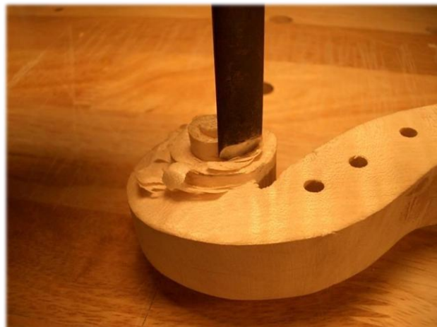
122. Elaborant el cargol del cap de la voluta.
