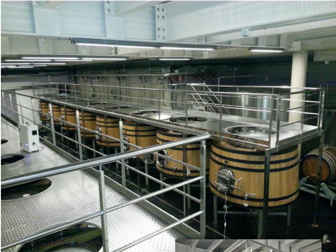
5. La sala de tines es troba just per sota del moll de recepció del raïm. Les tines són circulars i gràcies a unes estructures metàl·liques, que conformen passadissos, es pot accedir a la seva part superior.
