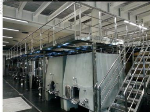
5. La sala de tines es troba just per sota del moll de recepció del raïm. Les tines són circulars i gràcies a unes estructures metàl·liques, que conformen passadissos, es pot accedir a la seva part superior.
