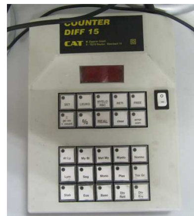
Fig. 15: Aparell per realitzar el recompte de cèl·lules sanguínies
