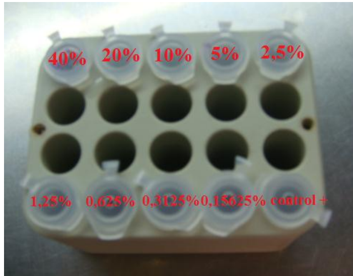
Fig. 69 Preparació de la corba de DMSO, en vermell, percentatge de DMSO de cada dilució.
