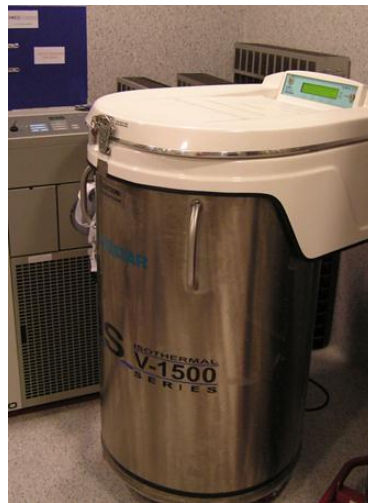
Fig. 35 Dipòsit de nitrogen líquid a -180°C.
