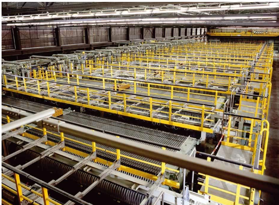
Il·lustració 4: Procés electròlisi industrial 18
