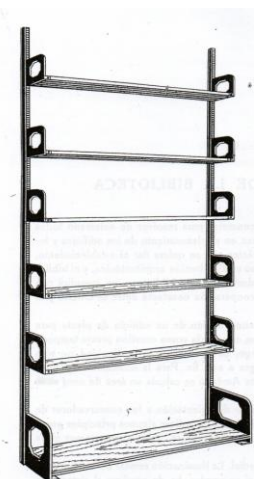
6-Prestatgeria de 6 nivells. Altura 2,25mAmple 1m.Font:Catalogación i ordenación de bibliotecas de Jordi Rubió i Balaguer
