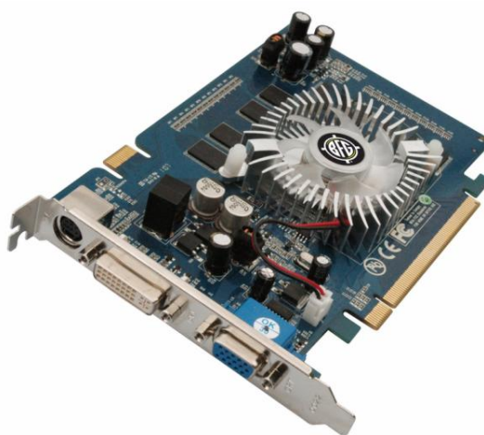
Targeta gràfica nVidia GeForce 7300GT amb les sortides S-Video (esquerra), DVI (centre) i VGA (dreta)
