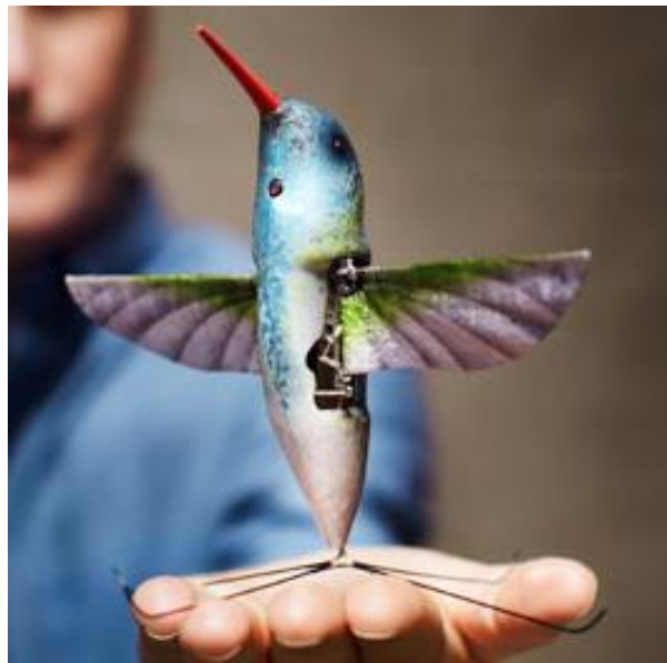
Figura 6. Nano UAV fabricat per AeriVironment, Inc. Té una duració de vol d'11 minuts i pot volar tan en espais tancats com a l'aire lliure.
