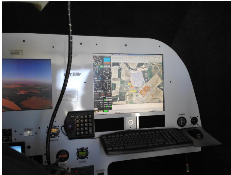
Figura 18. Cabina de control de l'empresa CATUAV. A l'esquerra la vista aèria que capta el drone amb una càmera de vídeo; a la dreta el control del comandament.
