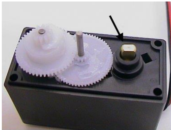
Imatge 26: Posició intermitja del potenciòmetre
