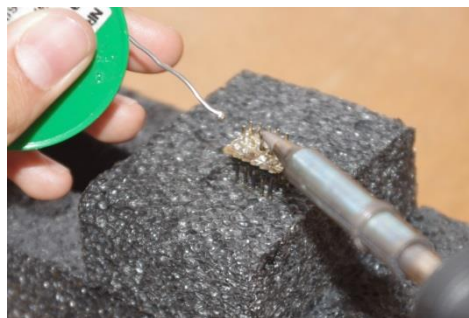
Imatge 16: Soldar els pins "dupont"
