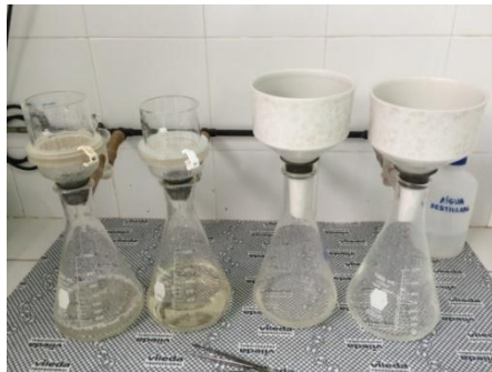
Sistema de filtració al buit amb embuts Büchner i matrassos Kitasato.
