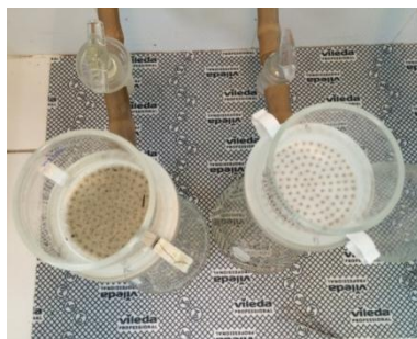
Aspecte dels filtres a través dels quals han passat mostres d'entrada, de sortida o de reactor biològic d'una EDAR.
