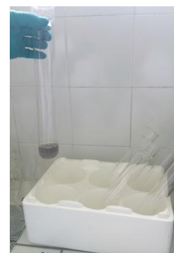
Tub de digestió amb mostra preparat per a la destil·lació.
