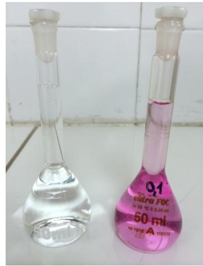
Dues mostres amb reactiu colorant de l'anàlítica dels nitrats. A la dreta, el blanc, a l'esquerra, mostra amb nitrats.
