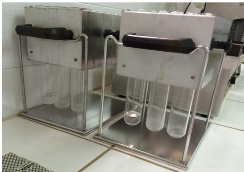
Tubs de digestió per a mostres de nitrogen Kjeldhal abans de la hidròlisi àcida.
