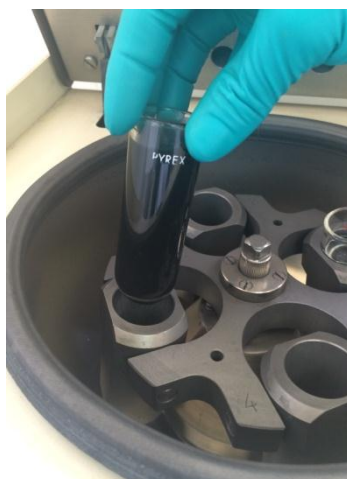
Introducció d'un tub a la centrifuga.
