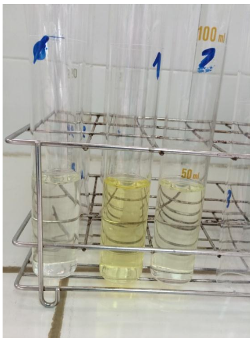
Mostres a punt de ser llegides a l'espectrofotòmetre. El groc més intens indica major concentració de fòsfor total.
