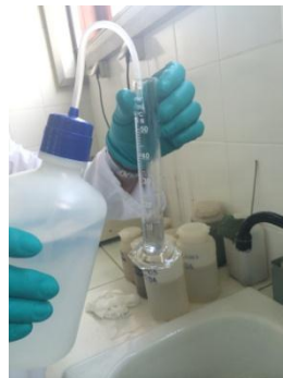
Transvès de 20 ml d'aigua destil·lada a la proveta i d'aquesta a un baló.
