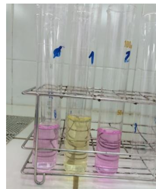
Mostres abans d'addicionar reactiu de vanadat-molibdat (rosades) i després (groga).
