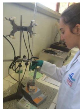
Afegint àcid sulfúric, gota a gota.
