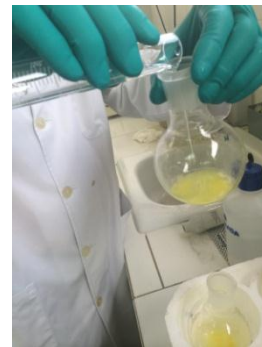
Transvès de 20 ml d'aigua destil·lada a la proveta i d'aquesta a un baló.
