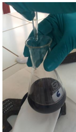
Decoloració progressiva d'una mostra afegint solució de tiosulfat sòdic.
