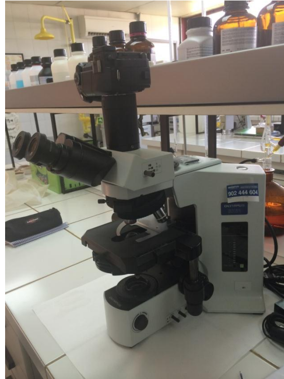
Microscopi òptic Olympus BX 51 amb càmera digital Olympus incorporada, amb el que s'han fet totes les fotografies dels microorganismes protagonistes d'aquest treball.
