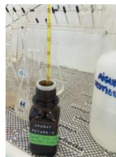
Presca d'1 ml d'indicador de \text{K}_2\text{CrO}_4 .
