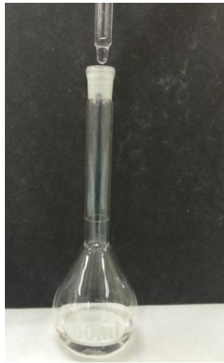
Recollida de mostra, gota a gota, després de passar a través de la columna de Cadmi.
