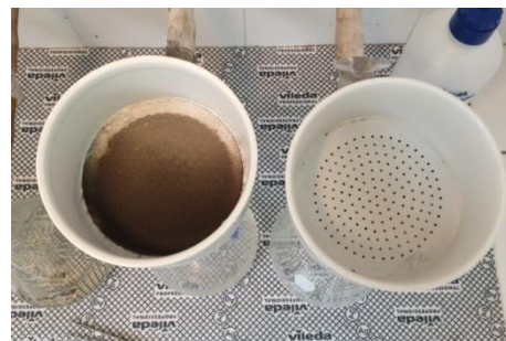
Aspecte dels filtres a través dels quals han passat mostres d'entrada, de sortida o de reactor biològic d'una EDAR.
