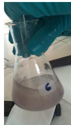
Decoloració progressiva d'una mostra afegint solució de tiosulfat sòdic.
