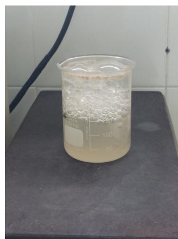
Mostra de fang de digester anaerobi centrifugat en ebullició.
