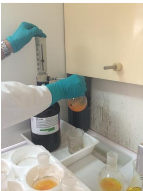
Addició d'àcid sulfúric concentrat i sulfat de plata als balons.
