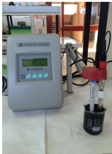
Lectura de conductivitat (a l'esquerra) i del potencial redox (a la dreta) d'una mostra de fang del digester anaerobi.
