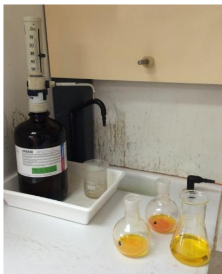
Mostres a punt per afegir àcid sulfúric concentrat.
