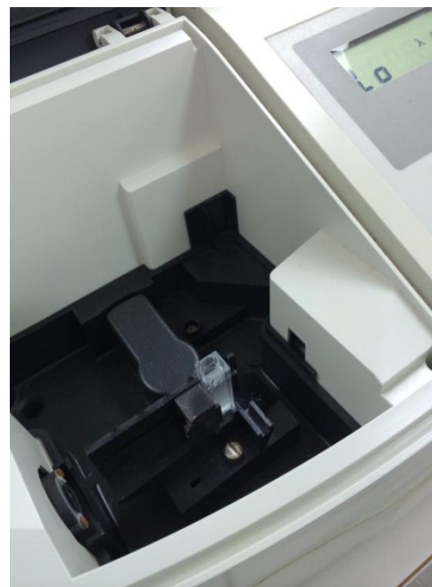
Interior de l'espectrofotòmetre amb una cubeta per a llegir el fòsfor total d'una mostra.
