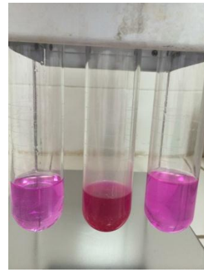
Addició d'indicador de fenolftal·leïna a les mostres i coloració final després d'afegir hidròxid sòdic.
