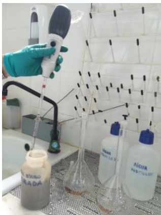
Presa de mostra amb la pipeta per introduir al matràs aforat.
