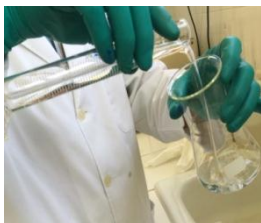
Addició de 50 ml d' \text{H}_2\text{O} destil·lada a un Erlenmeyer.
