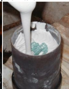
Procés final de muntar l'arbre, introduir-lo dintre el cilindre amb el revestiment i fosa de la cera, per obtenir l'arbre amb el metall i les diferents peces.
