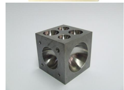
Per donar forma còncava a les peces s'utilitza els embotidors i el dau embotir.
