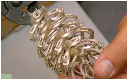
Procés final de muntar l'arbre, introduir-lo dintre el cilindre amb el revestiment i fosa de la cera, per obtenir l'arbre amb el metall i les diferents peces.
