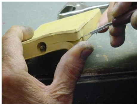
Procediment de dividir el motlle de silicona per extreure la peça de l'interior.
