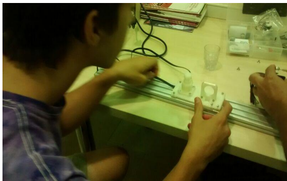
Montando Slider. Colocando la correa dentada.
