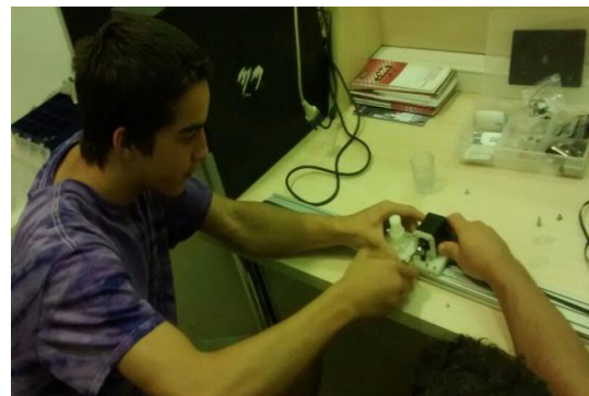
Atornillando el motor a la estructura de plástico.
