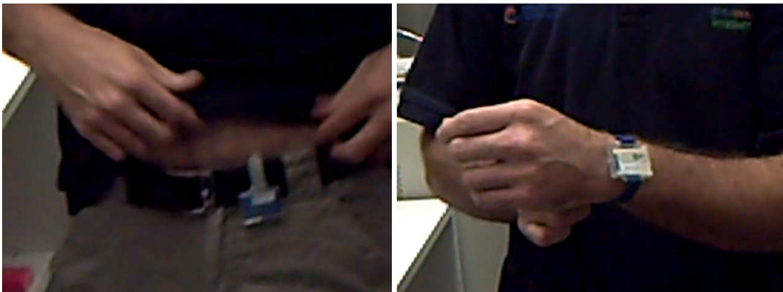
Dosímetre que queda sota el plom Dosímetre que queda descobert
