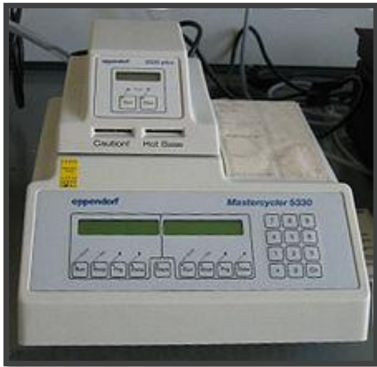
Figura 46. Termociclador: màquina que s'encarrega de realitzar i controlar els canvis de temperatura que requereix la tècnica de la PCR
