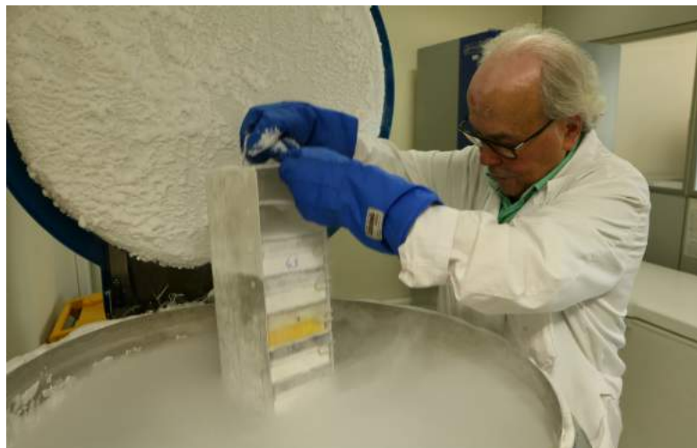
Figura 74 – Introducción de la torre en el tanque de nitrógeno líquido
