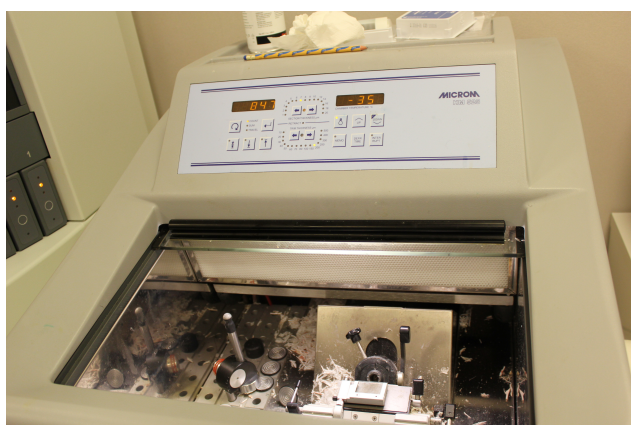
Figura 67: màquina on es duu el procés intraoperatori (-33° C) (II)
