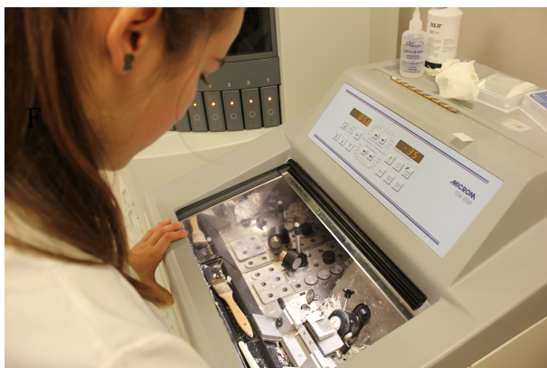
Figura 65: màquina on es duu el procés intraoperatori (-33° C) (I)
