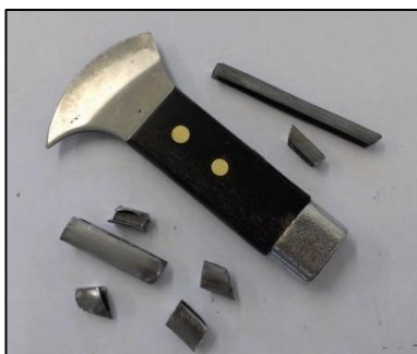
Espàtula per tallar el plom i cordons de plom de prova tallats
