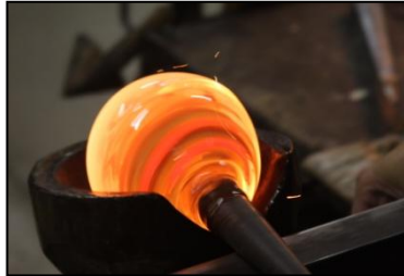
Motlle de fusta de cirerer, una de les eines amb les quals es donarà forma al vidre.
