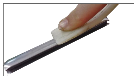
Mostra de com es fa servir l'eina alnova per allisar les tires de plom
