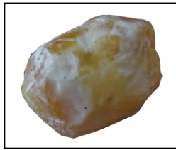
Greix que posarem sobre les unions del plom
