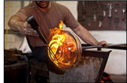
L'artista formarà i modificarà l'obertura de la peça amb diferents eines, mentre l'esclafa.
