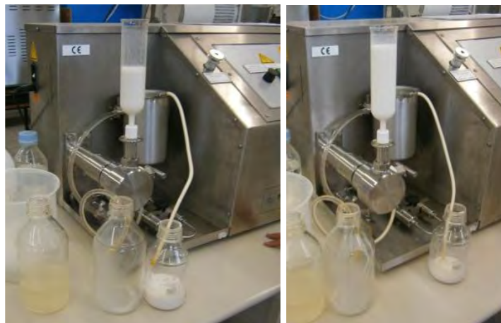
Figura 7 i 8: Introducció de la mostra per segona i per quarta vegada.
