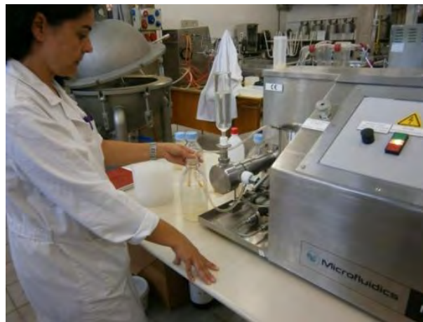
Figura 10: Neteja de la màquina amb aigua.
