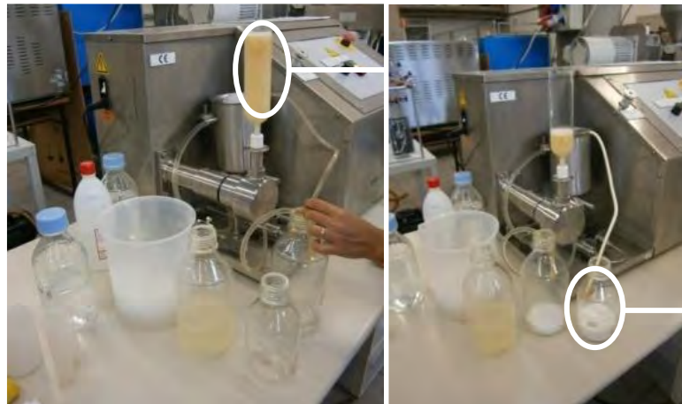
Figura 6: Introducció d'una mostra de menjar de rates per primera vegada a l'aparell i obtenció d'una mescla homogènia.
