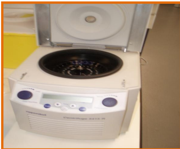
Fig. 22. Spin que centrifugarà les proteïnes per concentrar-les
