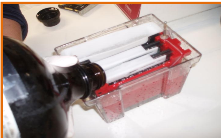
Fig. 26. Abocar Tampó Transfer 1x a l'interior de la cubeta mini-protean
