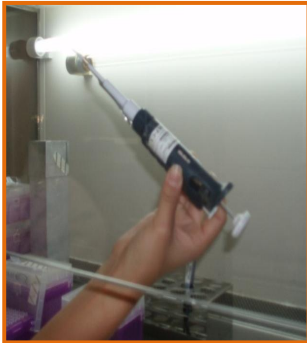
Fig. 14. Les pipetes resulten un estri de gran utilitat a l'hora d'aspirar volums força precisos. La punta de la pipeta és variable, i dependrà del volum que sigui capaç d'aspirar.
