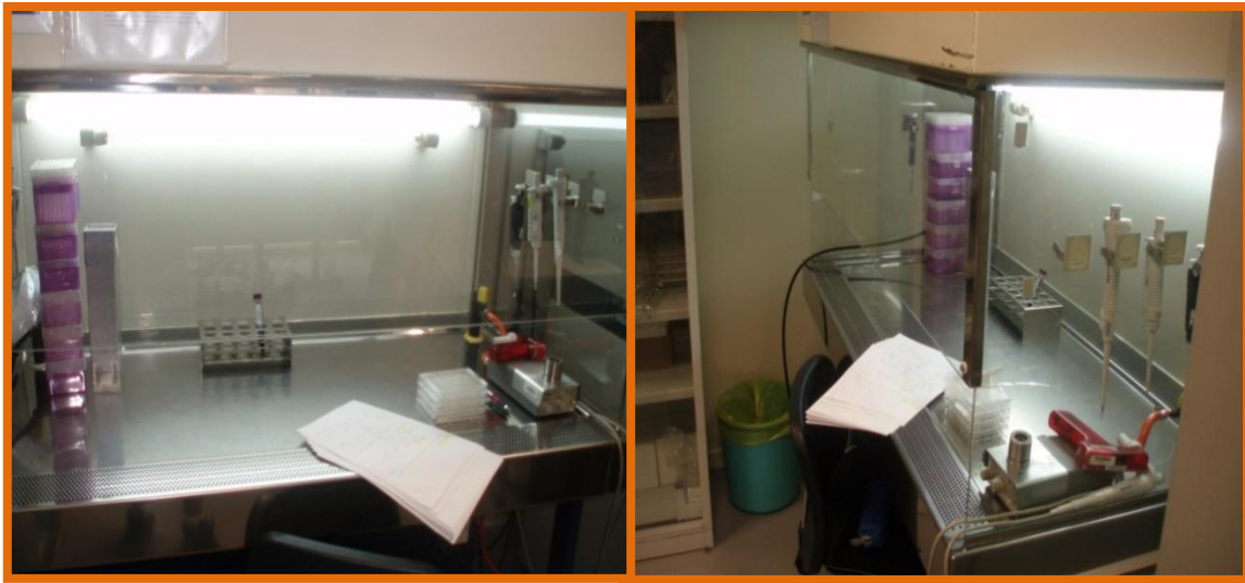
Fig. 9. Vistes frontal i de perfil de la cambra de flux laminar. Trobem el filtre HEPA a la part superior
