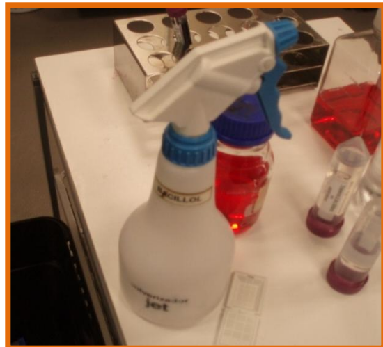
Fig. 8 Cal netejar amb alcohol desinfectant cada vegada que es deixa el lloc d'estudi. També fer una ruixada a les mans i a sobre els guants abans de tocar qualsevol reparació a l'interior de la campana de flux laminar.
