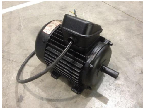
Figura 6. Motor trifàsic de 0.75 CV
