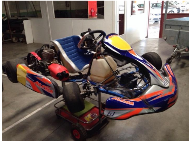
Figura 1. Kart amb motor de combustió 125cc de 2Temps.
