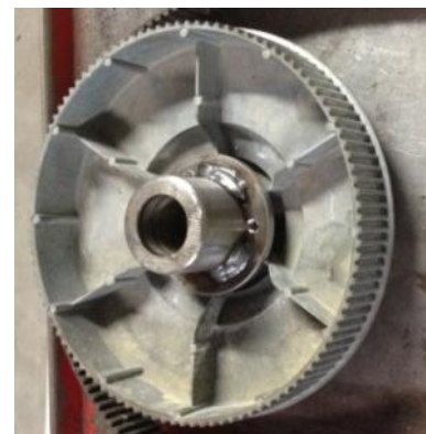
Figura 43. Suport fixat a la corriola dentada.
