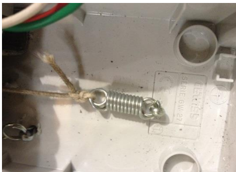
Figura 81. Molla encarregada de què no es trenqui el cordill fixada a la caixa.
