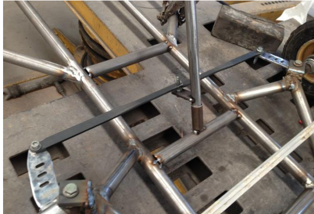
Figura 26. Eix de la direcció unit amb les manguetes.
