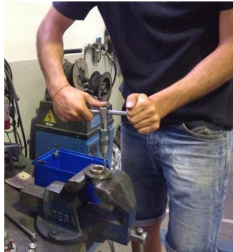
Figura 37. Detall del procés de fer rosca.
