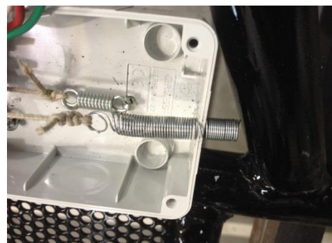
Figura 82. Molla encarregada de retornar el cordill fixada a la caixa.
