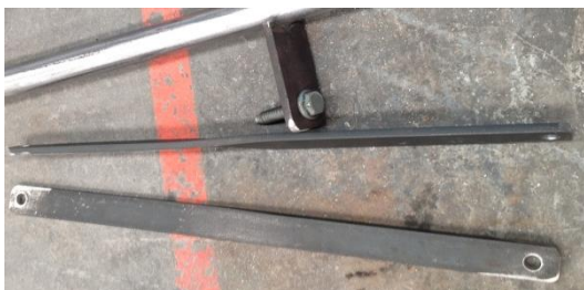
Figura 24. Braços i biela de la direcció
