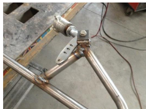
Figura 20. Vista final del suport i punts de recolzament de la mangueta.
