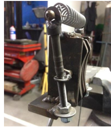
Figura 58. Cargol amb volandera fixat al mecanisme.
