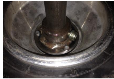
Figura 41. Roda collada a l'eix de transmissió.
