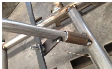
Figura 25. Braços i biela units a l'eix de direcció.
