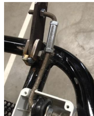
Figura 78. Vareta amb rosca amb l'entroncament.
