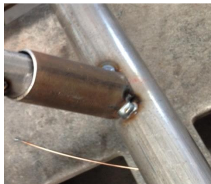
Figura 23. Suport barra de la direcció soldat al xassís.
