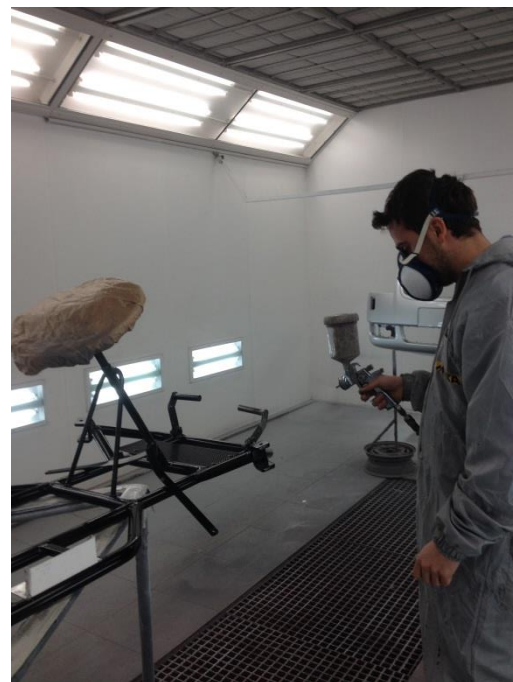
Figura 85. Detall del procés de pintat del xassís.
