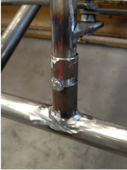
Figura 29. Mecanisme per a què l'eix de la direcció no es desplaça cap a dalt.
