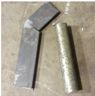
Figura 60. Tub i passamà doblegat per fer el pedal de fre.
