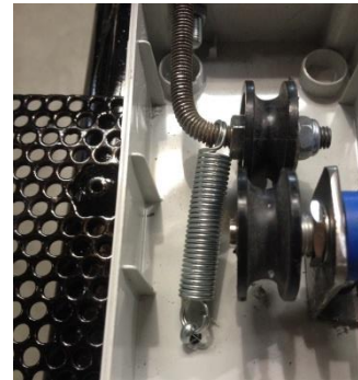
Figura 80. Molla encarregada de retornar el pedal fixada a la caixa.
