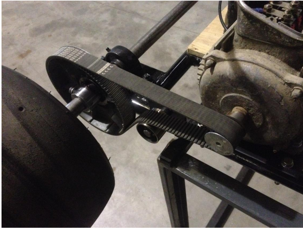
Figura 48. Transmissió completa del kart
