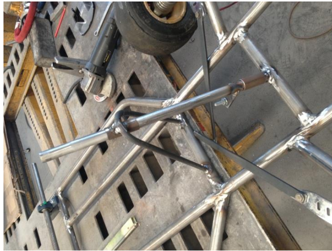
Figura 28. Suport de l'eix de direcció soldat.
