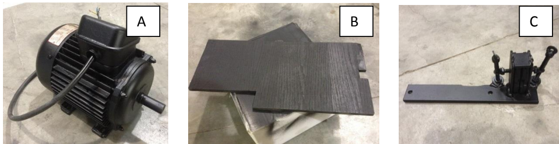
Figura 86. Motor (A), Suport bateries (B) i Mecanisme de fre (C) pintats amb esprai negre.
