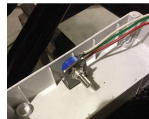
Figura 77. Potenciòmetre fixat a la caixa.
