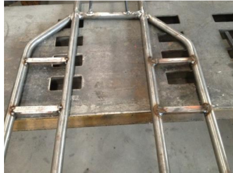
Figura 21. Vista final dels quatre suport per poder fixar el seient.
