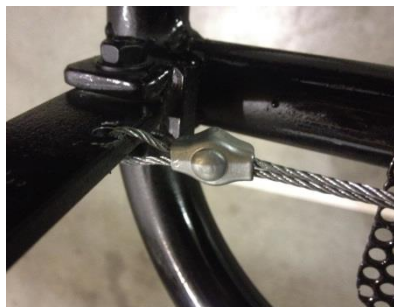
Figura 65. Sirga fixada amb un talla cables.
