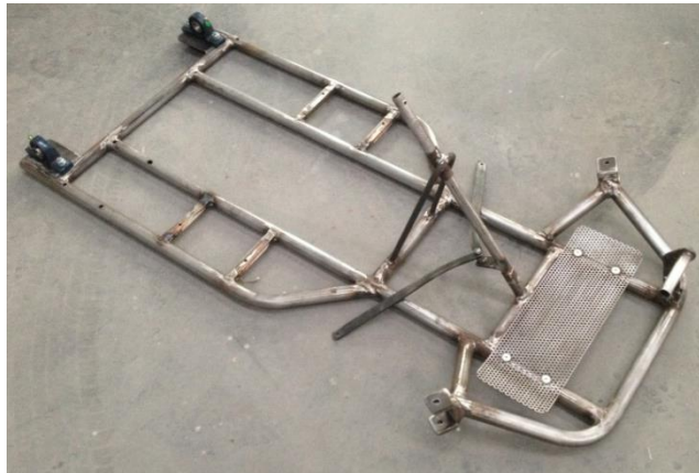
Figura 84. Xassís polit, preparat per pintar.
