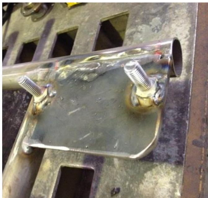
Figura 33. Cargols soldats cara amunt a sobre del suport per a fixar els coixinets.
