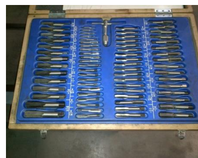
Figura 13. Filera (eina de fer rosca).
