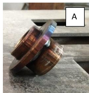
Figura 38. Suport per poder unir la roda amb l'eix de transmissió. Sense forats (A) amb forats i rosca (B).
