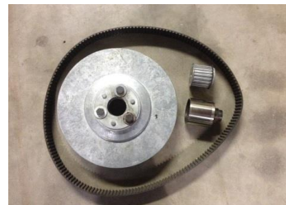
Figura 42. Corriola dentada, pinyó, tensor i corretja dentada
