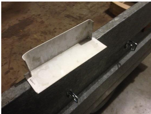
Figura 72. Suport per fixar variador.
