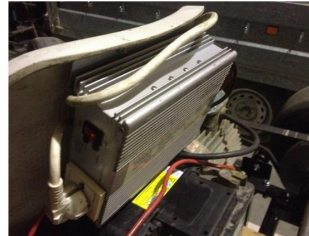
Figura 71. Inversor fixat al seient.
