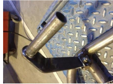
Figura 63. Pedal de fre fixat al xassís.
