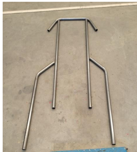
Figura 14. Principals peces d'acer per a l'estructura del kart en la posició oportuna.
