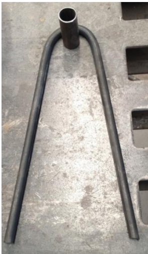
Figura 27. Peces que componen el suport de l'eix de direcció.
