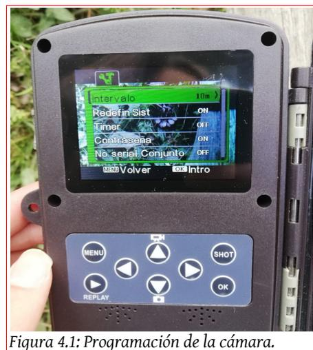
Figura 4.1: Programación de la cámara.
