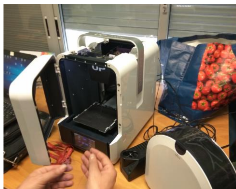
Il·lustració 45: Impressora Entresd Up Mini 2 utilitzada per imprimir els perfils
