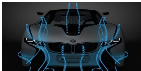
Il·lustració 10: Superfície frontal d'un cotxe amb les línies de vent corresponents.
