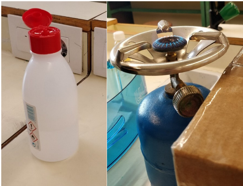
Figura 21. Alcohol i bec de Bunsen (fogonet) per esterilitzar. Font: Pròpia
