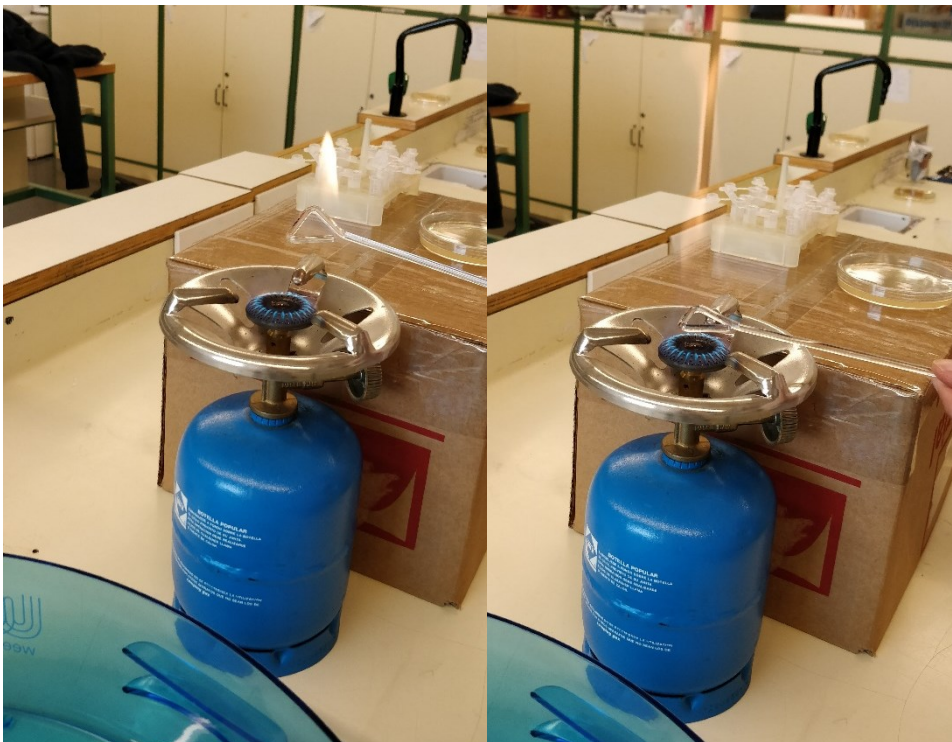
Figura 26. Esterilització de l'Assa de Digralsky cremant l'alcohol on s'hi trobava. Font: Pròpia.
