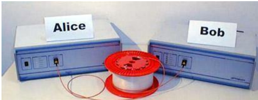
Fig. 4.7. Aparells comercialitzats per ID Quantique per poder establir comunicacions a través de criptografia quàntica.
