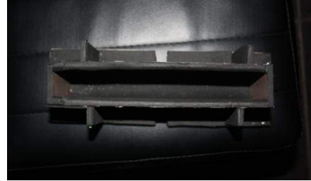
Goma EVA gruix 0'5 cm utilitzat per recobrir plataforma interna en forma de U.
