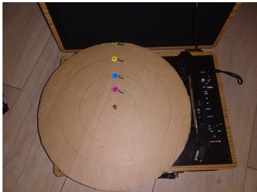
Imatge A2. Muntatge experimental cinemàtica. Gometes pels radis: rosa=4cm, blau= 7cm, groc=11cm, verd=15cm.
