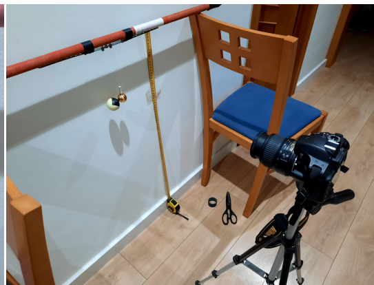
Imatge 7: Muntatge experimental preparat per l'enregistrament (boles de masses diferents).
