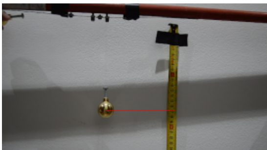
Imatge 8: Mesura de l'alçada inicial (17cm) de la bola en repòs (cas a, boles masses iguals).
