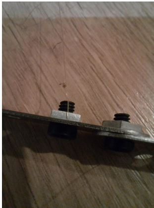
Imatge A8. Muntatge per regular la llargada del fil.
