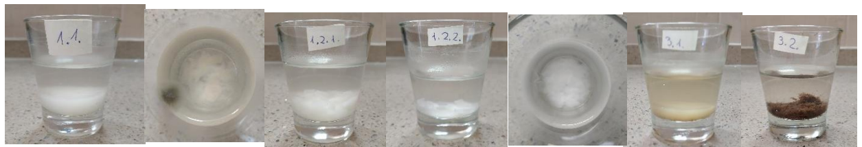
Figura 4.40: Resultats dels bioplàstics en aigua calenta
