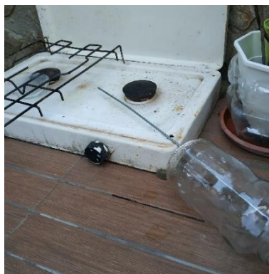
Figura 4.31: Accident després d'estar en contacte el vidre amb la flama
