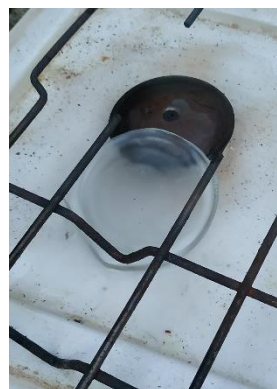
Figura 4.31: Accident després d'estar en contacte el vidre amb la flama
