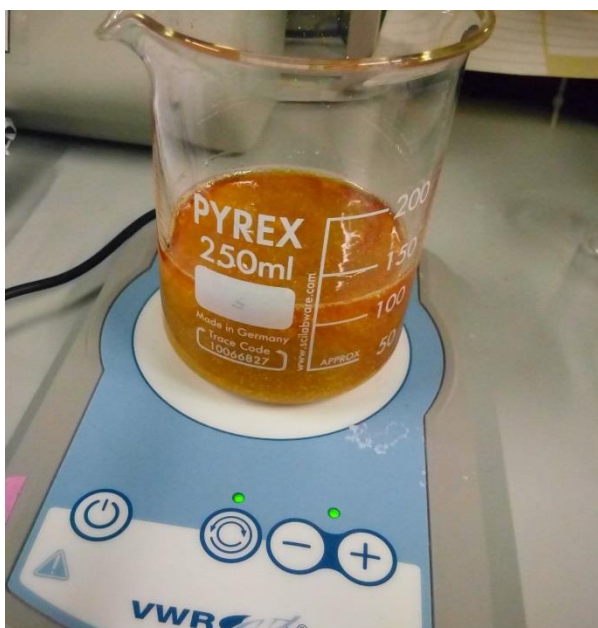
Recobriments de partícules superparamagnètiques amb sílice no porosa. Imatge obtinguda en les instal·lacions del PCB.
