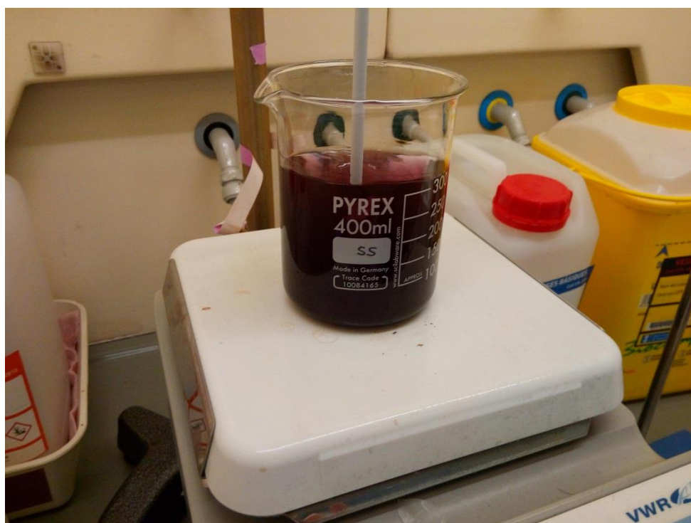
Procés de funcionalització de les partícules mesoporoses de sílice amb les nanopartícules d'or. Imatge obtinguda en les instal·lacions del PCB.
