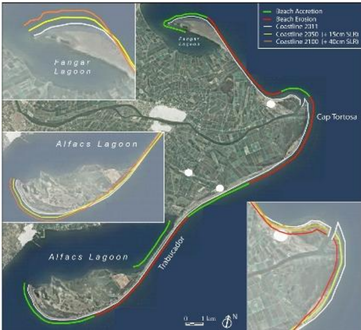
Fig 7: Zones erosives i zones d'acumulació del Delta. Previsió de les línies de costa del 2050 i el 2100. Font: UAB
