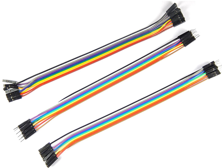
Fig 38. Exemple de cables jumper wires. (De dalt a baix) Femella a femella, mascle a mascle i femella a mascle.
