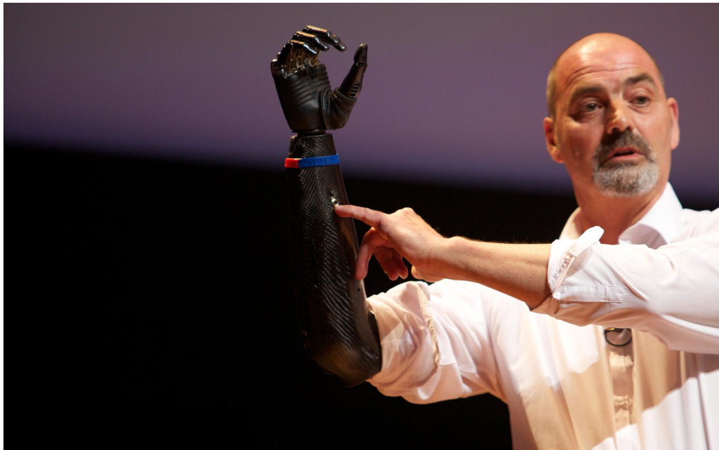
Fig. 22. Nigel Ackland amb la seva exopròtesi mecànica de braç Bebionic3, considerada la millor pròtesi de braç fins al moment.
