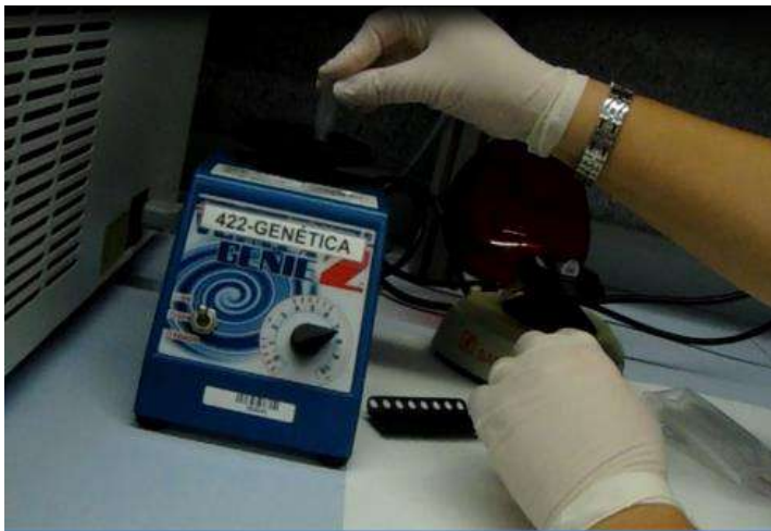
Fotografía mientras se realizaba el vortex a la izquierda y el spin a la derecha
