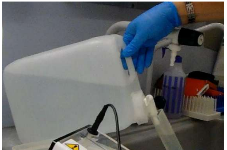
Fotografía mientras abocaba en una probeta de 100 ml, 100 ml de tampón TBE al 1%
