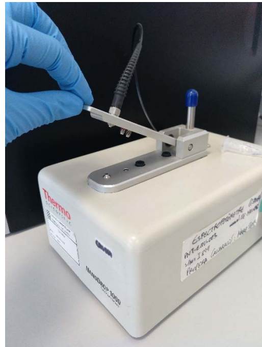
Figura 27. Quantificació de l'ADN amb el aparell NanoDrop 1000. (Font: Elaboració pròpia).
