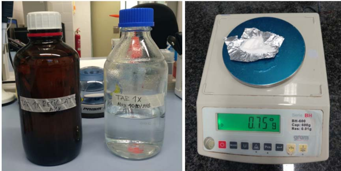
Figura 30. 1a) TAE 1x reciclat, aquest s'utilitza per omplir la cubeta d'electroforesi. 1b) TAE 1x nou, aquest s'utilitza per fer el gel d'agarosa. 2) 0,75g d'agarosa per fer el gel d'agarosa. (Font: Elaboració pròpia).
