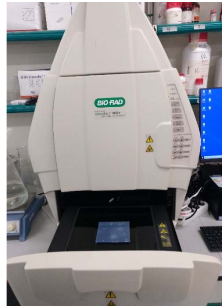
Figura 33. Gel d'agarosa amb l'ADN corregut col·locat en el visualitzador de gels Geldoc XR+. (Font: Elaboració pròpia).
