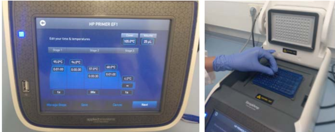
Figura 29. Programa executat (detallat a la Taula 6) i col·locació dels eppendorfs al termociclador. (Font: Elaboració pròpia).
