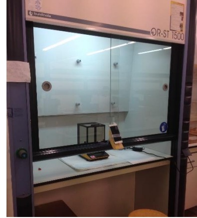
Campana extractora de gasos
