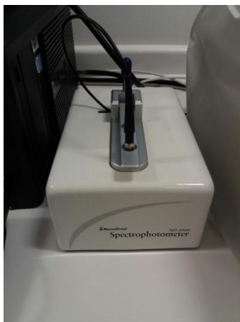
Figura 27. Espectofotòmetre on s'ha de carregar la mostra per ser llegida pel programa ND-1000 V3.5.2
