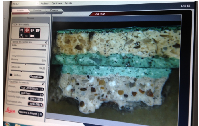
Imatge 11. Anàlisi de la composició d'una mostra de façana.
