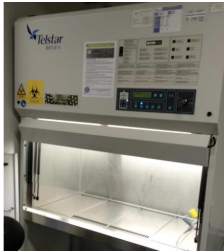
Figura 17. Cabina amb extractor per mantenir l'esterilitat durant la manipulació del material.
