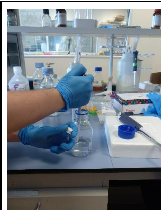
Figura 31: Transferint al vial de la fase orgànica els 750 µl de diclorometà amb l'ajuda del pipetejador especial per a solvents orgànics. Font: Estudi propi
