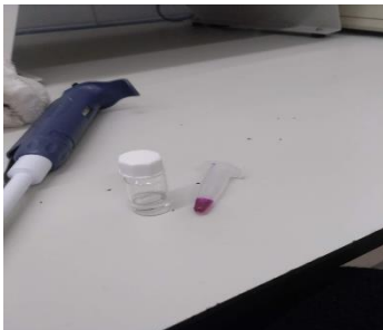
Figura 36: Vial amb la fase orgànica i tub d'Eppendorf amb la fase interna a punt per barrejar-se i dur a terme la primera emulsió. Font: Estudi propi
