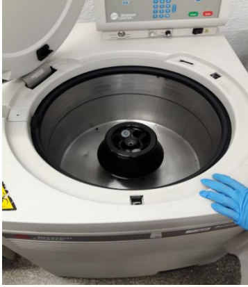
Figura 54: Centrifugadora amb els 2 tubs falcon amb les nanopartícules sense rodamina isotiocianat. Font: Estudi propi
