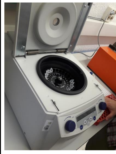
Figura 48: Centrifugadora amb els tubs d'Eppendorf amb les nanopartícules amb rodamina isotiocianat. (Hi ha més de 4 tubs d'Eppendorf degut a que vaig realitzar la pràctica amb més noies i per tant en vam col·locar més). Font: Estudi propi
