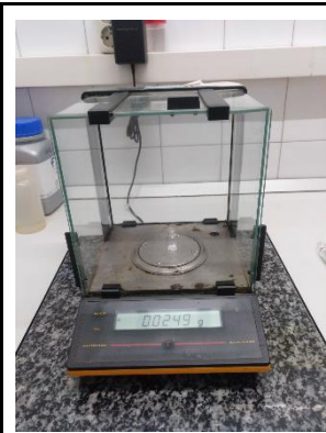
Figura 30: 24,9 mg de PLGA pesats en una balança analítica. Font: Estudi Propi
