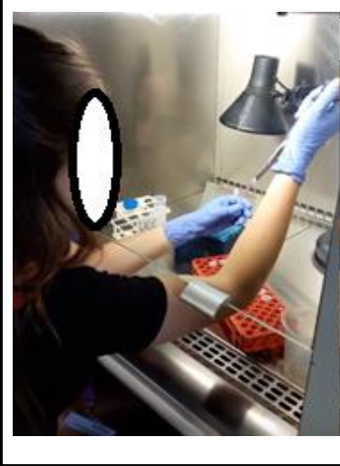
Figura 66: Introduint el medi de cultiu cel·lular (DMEM) amb el pipetejador al tub d'Eppendorf que conté nanopartícules de PLGA amb rodamina isotiocianat. Font: Estudi propi
