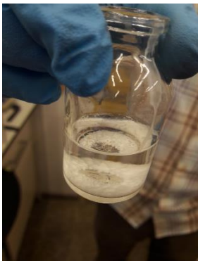
Figura 42: Mostra control de la primera emulsió (és de color blanc degut a que en la fase interna no hi conté rodamina isotiocianat) introduïda en el vial de la fase externa, a punt per a la sonicació.
