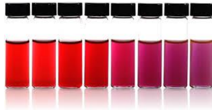
Figura 10: Nanopartícules d'or de diferents tamanyes en suspensió. Font: Nanocomposix
