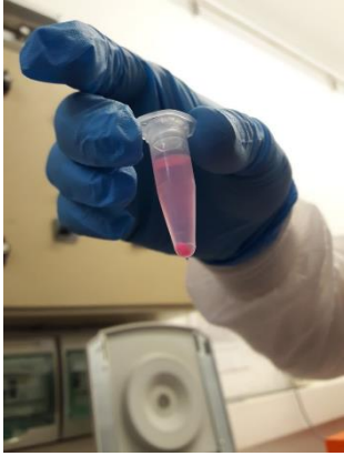
Figura 50: Tub d'Eppendorf amb les nanopartícules amb rodamina isotiocianat després de la primera centrifugació. Podem observar i distingir les nanopartícules acumulades a la part baixa d'un color rosa intens i el sobrenedant per a sobre de les nanopartícules.
