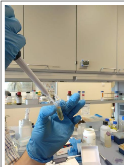
Figura 32: Transferint els 30 \mu l de SPAN-80 amb el pipetejador especial per a solvents orgànics. Font: Estudi propi
