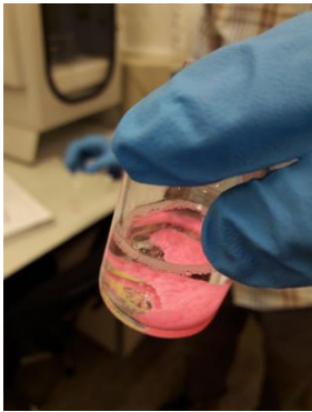
Figura 41: Primera emulsió amb la rodamina isotiocianat (part rosa) introduïda en el vial de la fase externa, a punt per a la sonicació.
