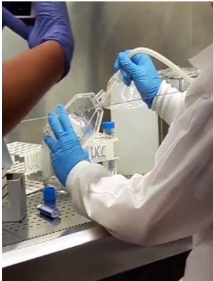
Figura 56: Extraient el medi de cultiu cel·lular del flascó amb la pipeta pasteur connectada a una bomba de buit. Font: Estudi propi
