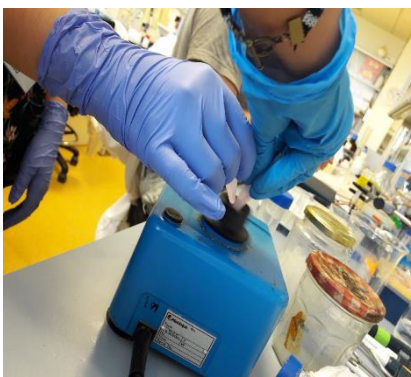
Figura 51: Resuspenent les nanopartícules amb l'ajuda del vòrtex. Font: Estudi propi
