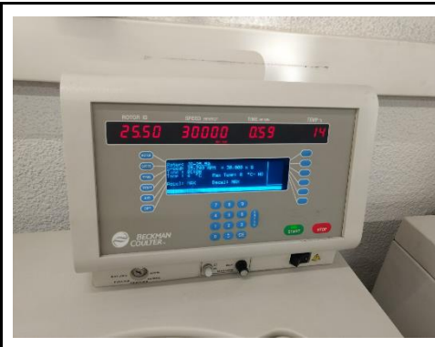
Figura 49: Condicions aplicades a la centrifugadora, a la pantalla es pot veure que hem programat la velocitat a uns 30000 G. Font: Estudi propi
