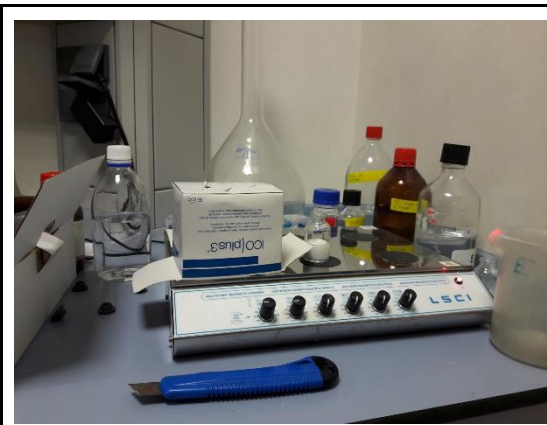
Figura 45: Els dos vials amb les segones emulsions deixant-se agitar overnight . El vial tapat amb una capsa de cartró amb forats és el de la mostra que conté la rodamina isotiocianat, la qual és fluorescent, per això es cobreix, per tal de no perdre la seva fluorescència. Font: Estudi propi
