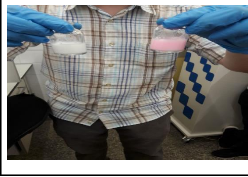
Figura 43: Resultat de les dues segones emulsions. El vial de l'esquerra (el que conté la substància blanca) és la mostra control, la qual no conté rodamina isotiocianat, per això l'observem el color blanc degut al PLGA. El vial de la dreta (el que conté la substància rosa) és la que conté les nanopartícules amb rodamina isotiocianat. Font: Estudi propi
