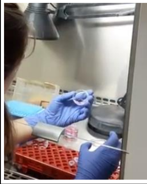
Figura 69: Placa de petri amb cèl·lules HeLa sembrades després d'extreure'ls-hi el medi de cultiu (DMEM). En la fotografia es pot observar el cobreobjectes enganxat a la placa de petri. Font: Estudi propi
