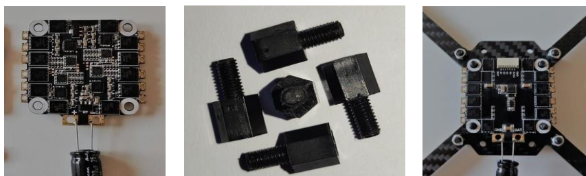
Figura 56 Acoblament de la placa reguladora de velocitat al frame. Font: Pròpia
