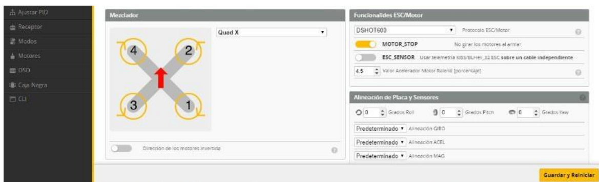
Figura 71 Selecció del tipus de dron i del model de la placa reguladora de velocitat. Font: Pròpia
