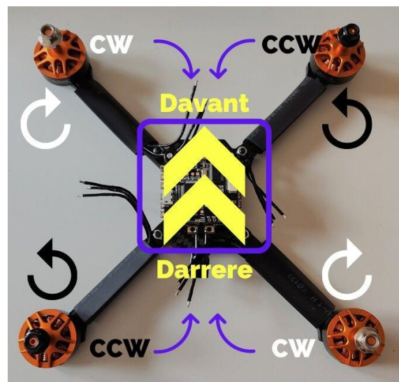
Figura 57 Esquema del funcionament i sentit de gir dels motors del dron. Font: Pròpia
