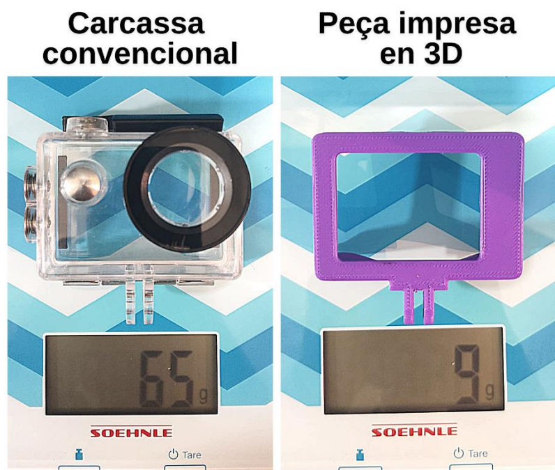
Figura 90 Resultat del suport de la càmera i comparació amb el suport convencional. Font: Pròpia
