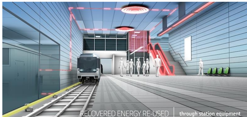
Il·lustració 10 L'estació de metro Hesop aprofita l'energia que allibera el tren en frenar. Font: www.structuralia.com
