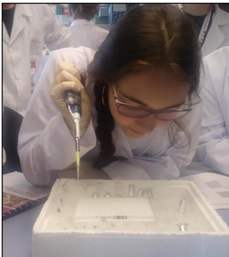
Il·lustració 88. Es pipeteja 2 ul DNA a cada foradet de la plata, dins el gel. Els tubs estan coberts amb paper de plata perquè contenen la barreja de la PCR. (Fotografia pròpia)
