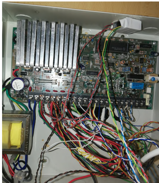
Figura A.7: Placa central del sistema d'alarma C&K 236
