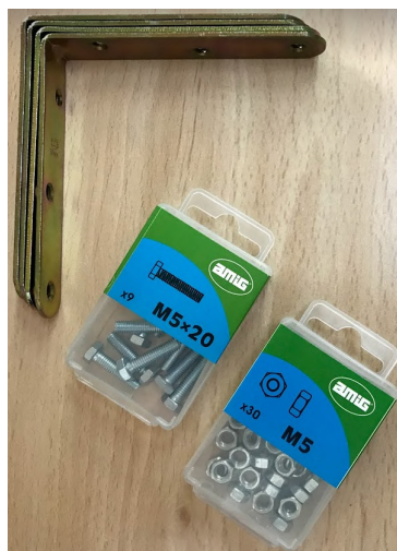
Figura 3.20: Peus metàl·lics i femelles i cargols M5 \times 20 per insirer-los
