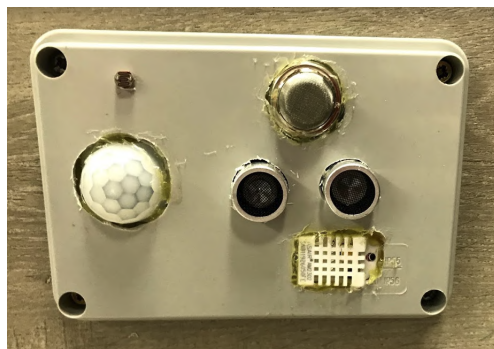
Figura 3.28: Creació d'un mòdul per unificar els sensors
