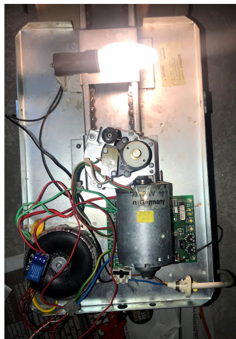
Figura A.4: Connexió d'un relé a l'esquema del motor
