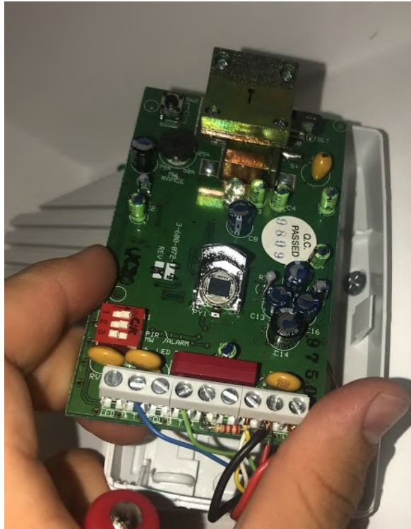
Figura A.8: Canvi de resistències dels sensors per adaptar el sistema a la central BOSCH Font: Creació pròpia
